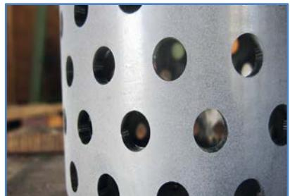
L'innovativa tecnologia SuperCups è una soluzione brevettata relativa ad elementi interni del reattore Urea che possono favorire la resa della sintesi Urea. La soluzione SuperCups permette di migliorare notevolmente la miscelazione dei reagenti ottimizzando così il tasso di conversione del prodotto nel reattore. Questo aumento di efficienza di conversione produce benefici diretti sulle prestazioni giornaliere, tra cui un minore consumo energetico e un ridotto impatto ambientale.
