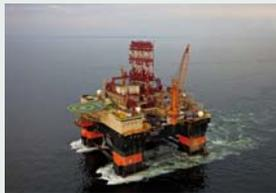
в то время как Scarabeo 9 – полупогружная платформа со сдвоенным гидроцилиндром для работы в умеренных условиях. Обе платформы оборудованы системой динамического позиционирования класса 3 (DP3), повышающей эксплуатационную эффективность и управляемость платформы в чрезвычайных ситуациях.
